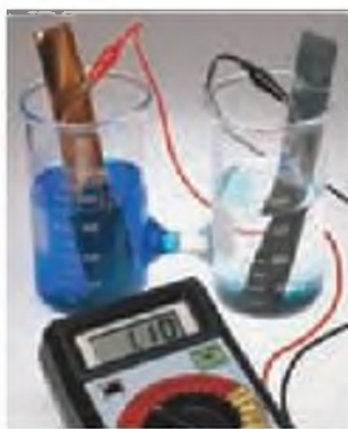
▲ Figura 20.4 Una celda voltaica basada en la reacción de la ecuación 20.7. El compartimiento de la izquierda contiene \text{CuSO}_4 1 M y un electrodo de cobre. El de la derecha contiene \text{ZnSO}_4 1 M y un electrodo de zinc. Las disoluciones están conectadas mediante un disco de vidrio poroso, el cual permite el contacto entre las dos disoluciones. Los electrodos de metal están conectados a través de un voltímetro, el cual registra el potencial de la celda, 1.10 V.
